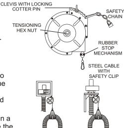
THE BA BALANCER INSTALLED ON THE CEILING AND WALL PLATFORM. FOR DUAL SYSTEMS, TWO BALANCERS MAY BE USED, ONE ON EACH SIDE OF THE PLATFORM.
